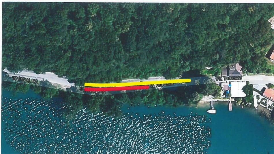
**Figura 2:** Situazione generale, in rosso è indicato il risanamento del cordolo, in giallo il risanamento della pavimentazione.
