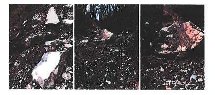
Qui sopra abbiamo a sinistra un elemento da 1.25 mc e nelle due foto di centro e destra, l'elemento più grande rilevato sull'accumulo di frana per un volume di ca. 6.85 mc per un peso di ca.17.5 ton adagiato sul detrito di frana di granulometria decisamente inferiore.
